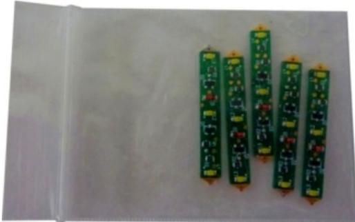
Ce 'LIGHT-SHIELD' de Grothe est une plaque d'insertion pour boutons poussoirs.
