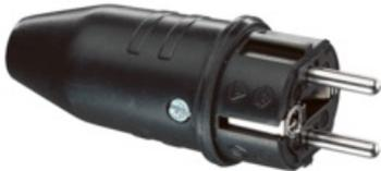
Fiche SCHUKO mâle en caoutchouc, noir, 2 systèmes de mise à la terre, IP44, espace de connexion 3 x 2,5 mm<sup>2</sup>
